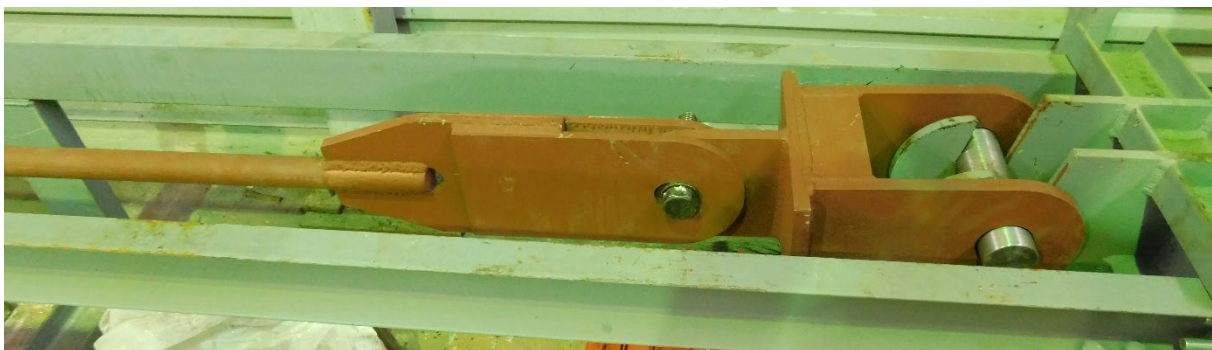
Рис. 4. Жесткое закрепление раскоса на испытательном стенде
