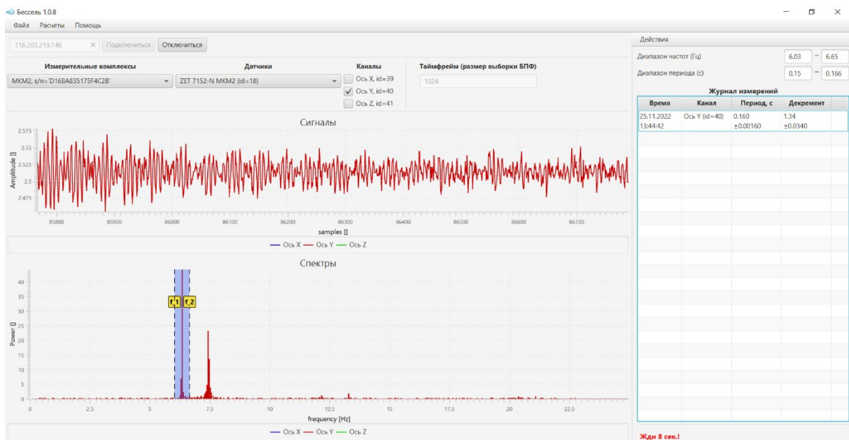
Рис. 5. Определение периода собственных колебаний раскоса при тяжении 8 тонн по средствам датчиков и ПО СММК BESSEL .
